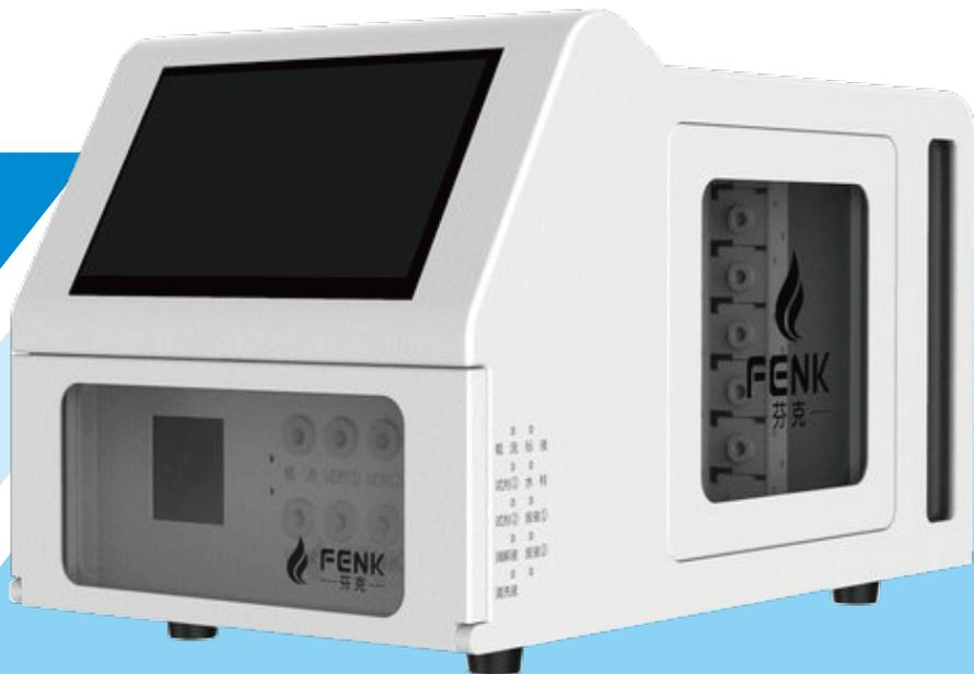
芬克总磷/磷酸盐自动分析仪 (MFIA-102-TP/P) 是基于流动注射分析技术的基本原理，由芬克自主开发的流动分析系统构成，并结合紫外光催化消解技术，利用磷酸盐/钼酸铵/酒石酸锑钾/抗坏血酸显色反应体系，实现了总磷/磷酸盐 (TP/P) 自动、快速、准确分析的检测仪器。
